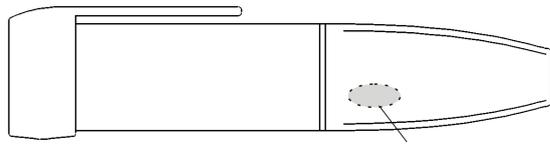
Localización Del Sensor Interna De Temperatura
