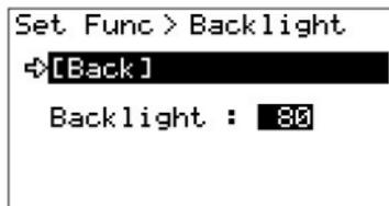
Si el dispositivo lleva más de cinco segundos sin utilizarse, la retroiluminación de la pantalla LCD se apagará de forma automática para conservar la energía de las pilas.
